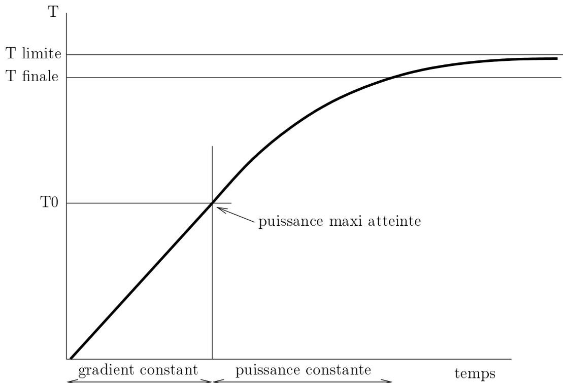
FIGURE 11 – les deux phases d'une cuisson.
