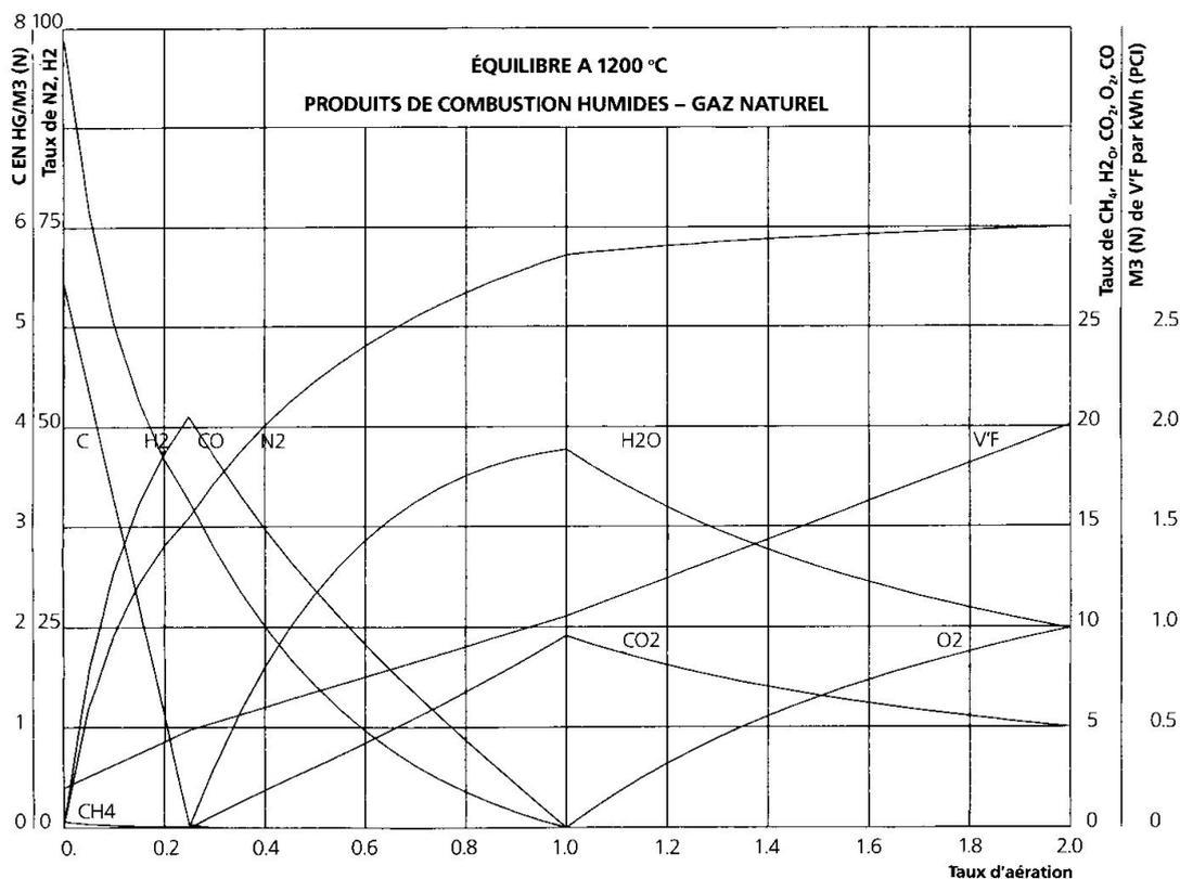
FIGURE 2 – diagramme d'équilibre humide d'un gaz naturel.
