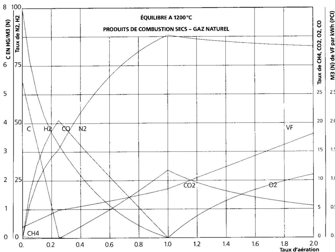
FIGURE 1 – diagramme d'équilibre sec d'un gaz naturel.
