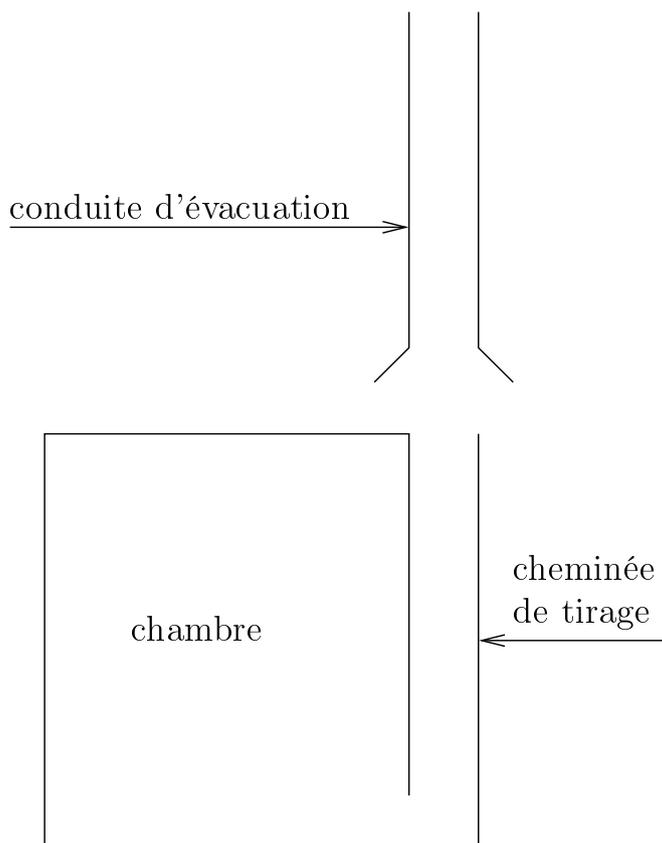
FIGURE 12 – schéma d'un four à gaz
