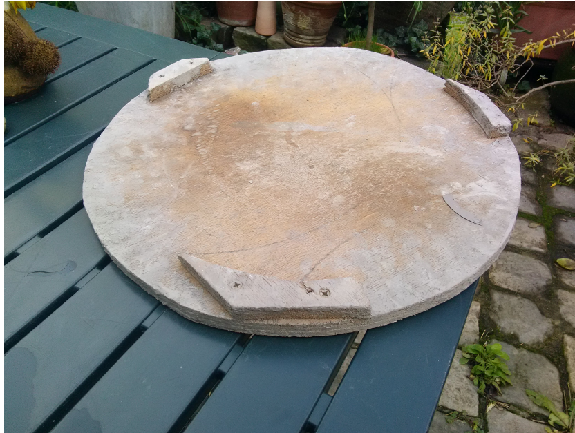
FIGURE 2 – rondeau pour girelle alu, face inférieure.
