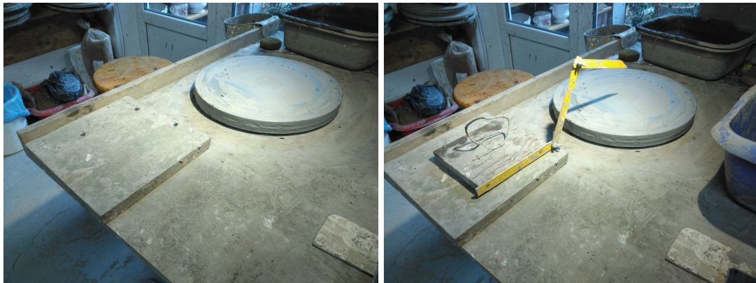
FIGURE 3 – feuille de CP et trusquin en place.
